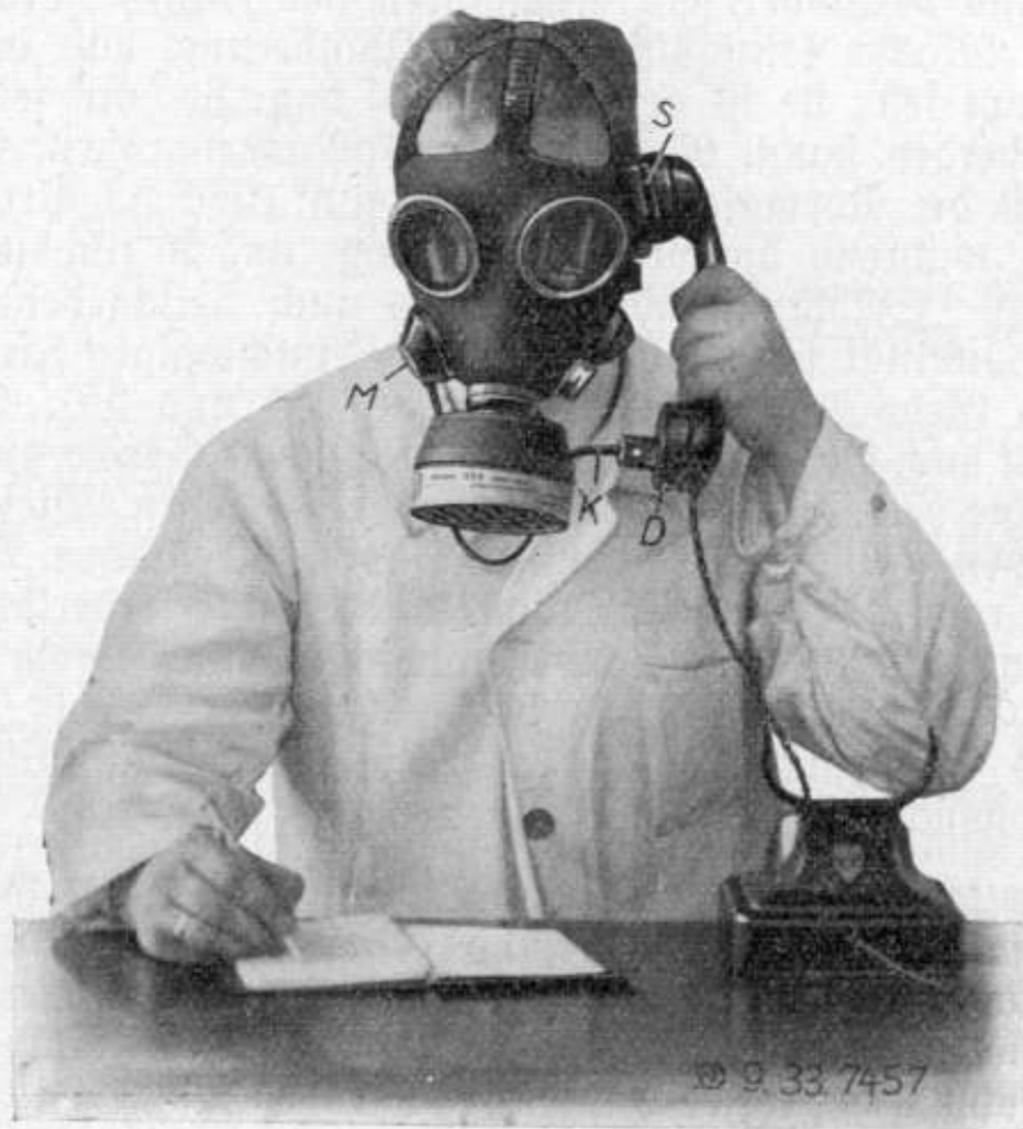
Abb. 54. Telefonmaske mit eingebauter Sprechmembrane.
