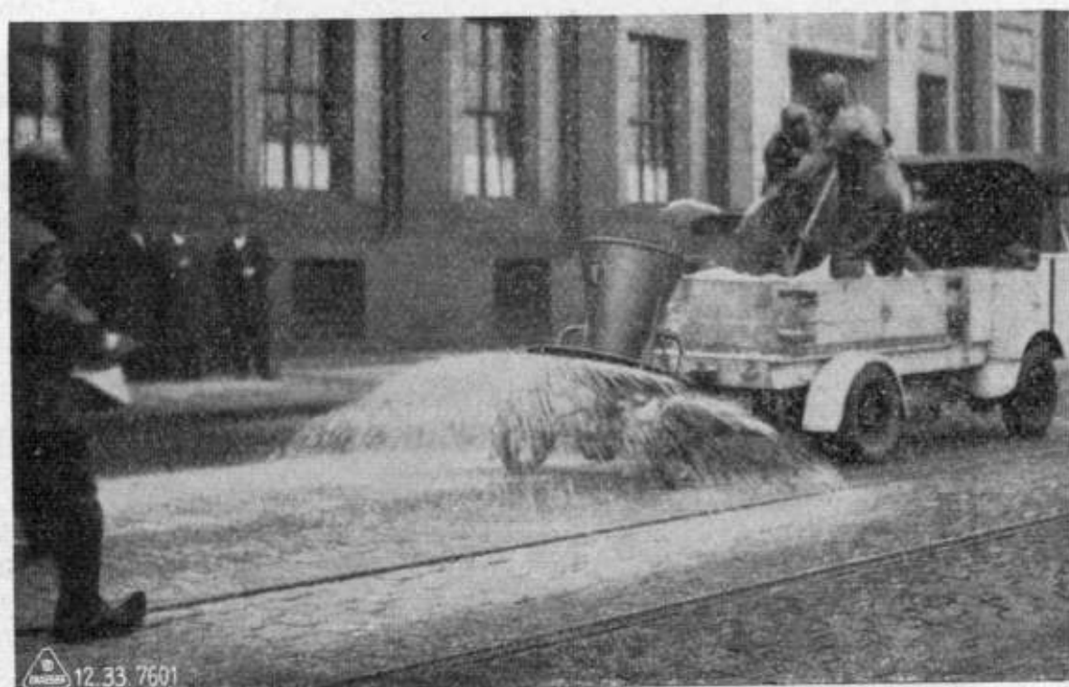
Abb. 87. Sandstreumaschine als Chlorkalkstreuer.
