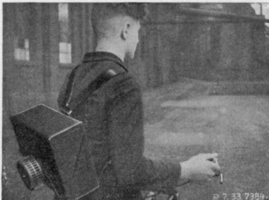
Abb. 89. Warnung in einem Industriewerk mit fahrbarer Sirene.
